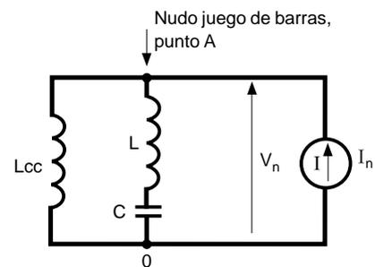
**Fig. 17:** Autoinducción puesta en serie con el condensador.
