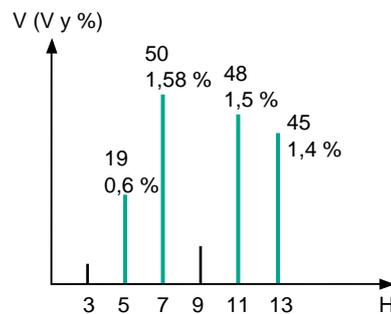
**Fig. 31:** Espectro de las tensiones armónicas de una red  $5,5$  kV equipada con un dispositivo de inductancia antiarmónica. La amplitud de los armónicos se expresa aquí en voltios o en porcentaje de la tensión simple ( $5,5 \text{ kV} / \sqrt{3}$ ).
