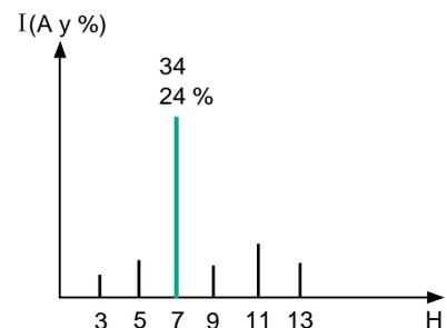
**Fig. 32:** Espectro de corrientes armónicas que atraviesan los condensadores en una red equipada con un dispositivo de inductancia antiarmónica.
