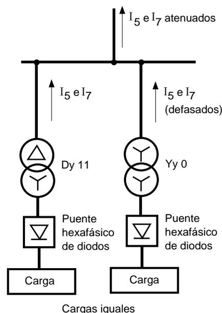
**Fig. 7:** Montaje atenuante de  $I_5$  e  $I_7$ .
