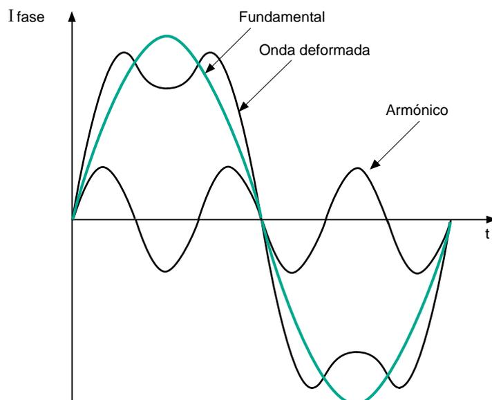
**Fig. 1:** Imagen de una onda deformada.
