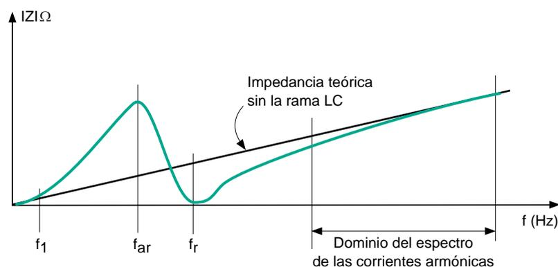
**Fig. 20:** Si  $f_r$  queda por debajo del espectro del armónico los condensadores están bien protegidos.
