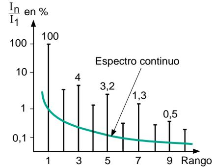
Fig. 9: Espectro de corriente que alimenta un horno en corriente alterna.
