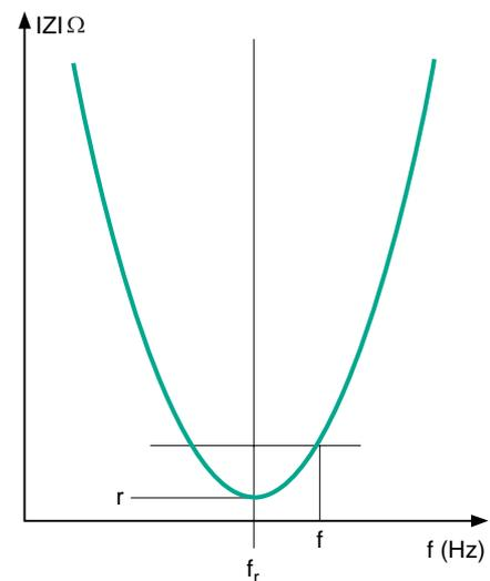
Fig. 22: Curva  $Z = f(f)$  de un shunt resonante.
