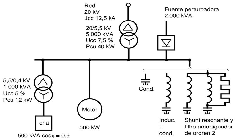
**Fig. 26:** Instalación con un elemento perturbador, condensadores y filtros.
