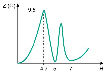
**Fig. 33:** Curva de la impedancia armónica vista desde el nudo de inyección de las corrientes armónicas en una red equipada con un filtro shunt resonante en el rango 5 y un filtro amortiguado en el rango 7.
