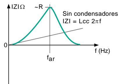
**Fig. 15:** Variación de la reactancia y del módulo de la impedancia del esquema equivalente.
