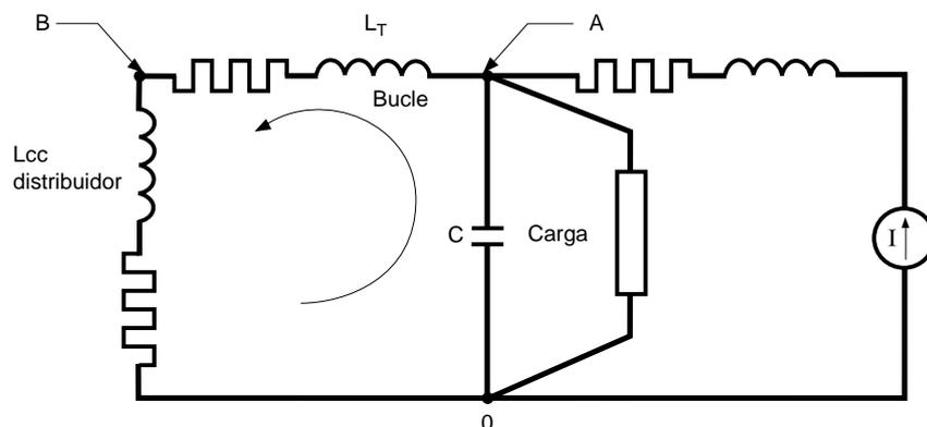
**Fig. 16:** El condensador constituye, con la suma de impedancias aguas arriba, un circuito resonante.
